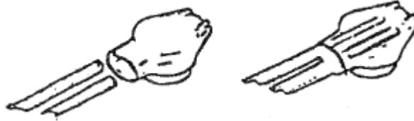
Σχήμα B1.3.22 Εισαγωγή άκρων αγωγών στον συνδετήρα
