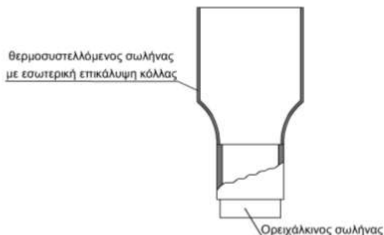
Σχήμα Β1.3.20 Σωλήνες προσαρμογής τερματικών καλωδίων
