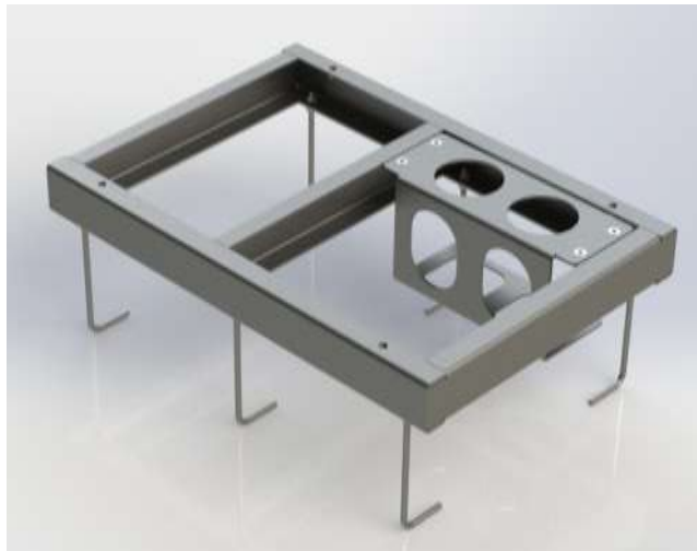
Σχήμα A.9.3.2 Μεταλλικό πλαίσιο βάσης στήριξης καμπίνας
