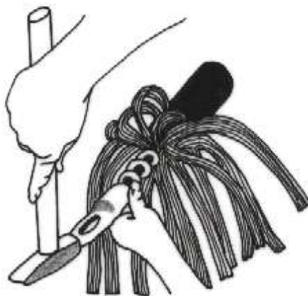
Σχήμα B1.5.2 Τοποθέτηση αγκίστρου στο άκρο του καλωδίου
