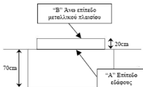
Σχήμα Α.9.1.7 Επίπεδα σκυροδέτησης
