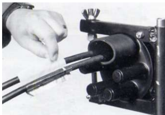
Σχήμα B2.3.14 Τοποθέτηση των φύλλων αλουμινίου
