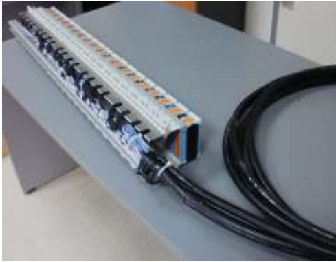
Σχήμα A9.2.4β Προκαλωδιωμένα στοιχεία τερματισμού ΚΔ (300 ζεύγη σε monoblock 5 στοιχείων MDF splitter) και ΑΔ (50+100 ζεύγη σε BRCP-HD 160 ορίων) για χρήση σε καμπίνα Γ3.
