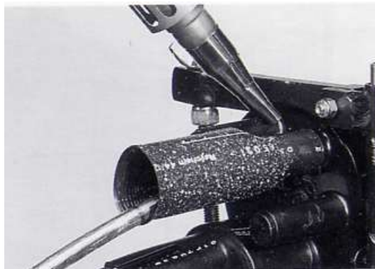
Σχήμα B2.3.40 Συρρίκνωση του θερμοσυστελλόμενου σωληνίσκου
