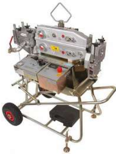
Σχήμα Β2.2.1 Τεχνική τοποθέτησης ΚΟΙ σε σωλήνωση με την μέθοδο της εμφύσησης
