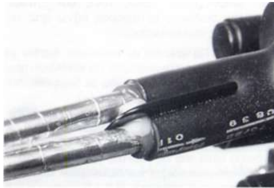
Σχήμα B2.3.17 Ολοκλήρωση διαδικασίας τοποθέτησης θερμοσυστελλόμενου σωλήνα στην οβάλ είσοδο της βάσης
