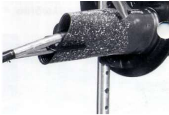
Σχήμα B2.3.16 Θέρμανση θερμοσυστελλόμενου σωλήνα
