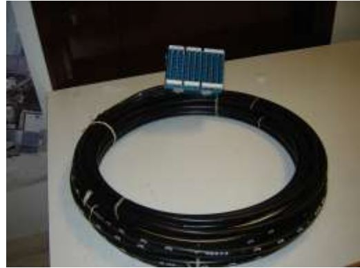
Σχήμα A9.2.4β Προκαλωδιωμένα στοιχεία τερματισμού ΚΔ (300 ζεύγη σε monoblock 5 στοιχείων MDF splitter) και ΑΔ (50+100 ζεύγη σε BRCP-HD 160 ορίων) για χρήση σε καμπίνα Γ3.
