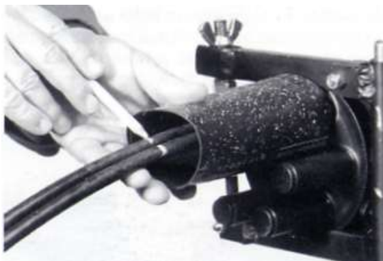
Σχήμα B2.3.13 Σήμανση άκρων θερμοσυστελλόμενου σωλήνα
