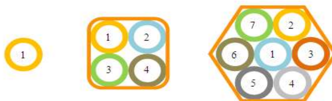
Τυπικό σύστημα πολυσωλήνων για άμεσο ενταφιασμό ( \mu DE-B) με 1, 4, και 7 μικρο-σωλήνες τύπου A1 ή τύπου B1.
