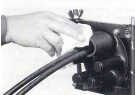
Σχήμα B2.3.10 Καθαρισμός της οβάλ εισόδου
