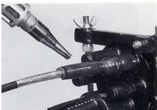
Σχήμα B2.3.41 Ολοκλήρωση της διαδικασίας συρρίκνωσης του θερμοσυστελλόμενου σωληνίσκου
