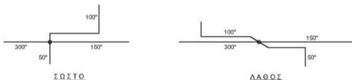
Σχήμα Β1.3.1 Υπόδειξη σωστής θέσης για την κατασκευή διακλαδωτικού συνδέσμου.
