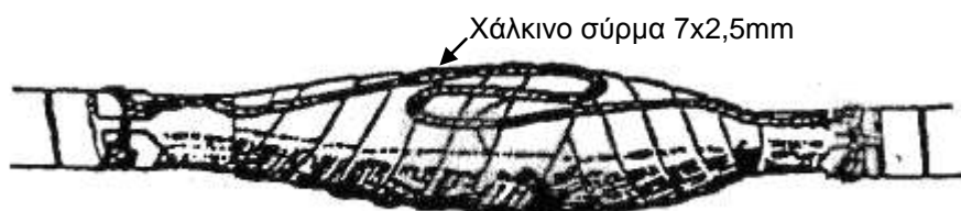
Σχήμα Β1.3.5 Εξασφάλιση ηλεκτρικής συνέχειας οπλισμού στον σύνδεσμο.
