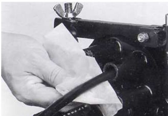
Σχήμα B2.3.37 Καθαρισμός στρογγυλής εισόδου
