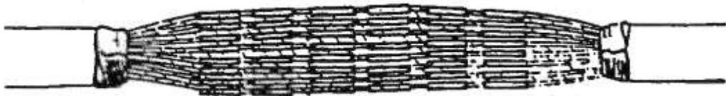
Σχήμα B1.3.11 Εικόνα συνδεδεμένων καλωδίων μετά το τέλος της πλέξης
